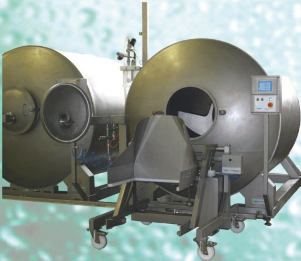
Beschickung mit Liniengeführter HKV 200, geöffneter Deckel mit Vakuumschnorchel und Salzdüse
