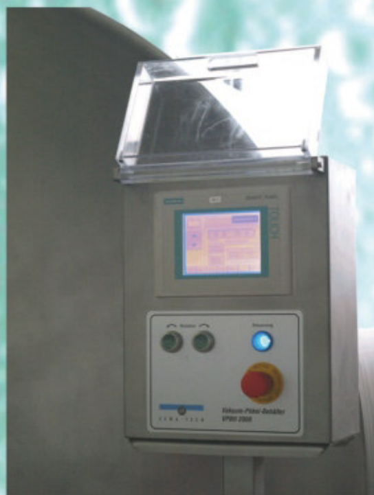
Steuerung: Siemens SPS mit TP 170
