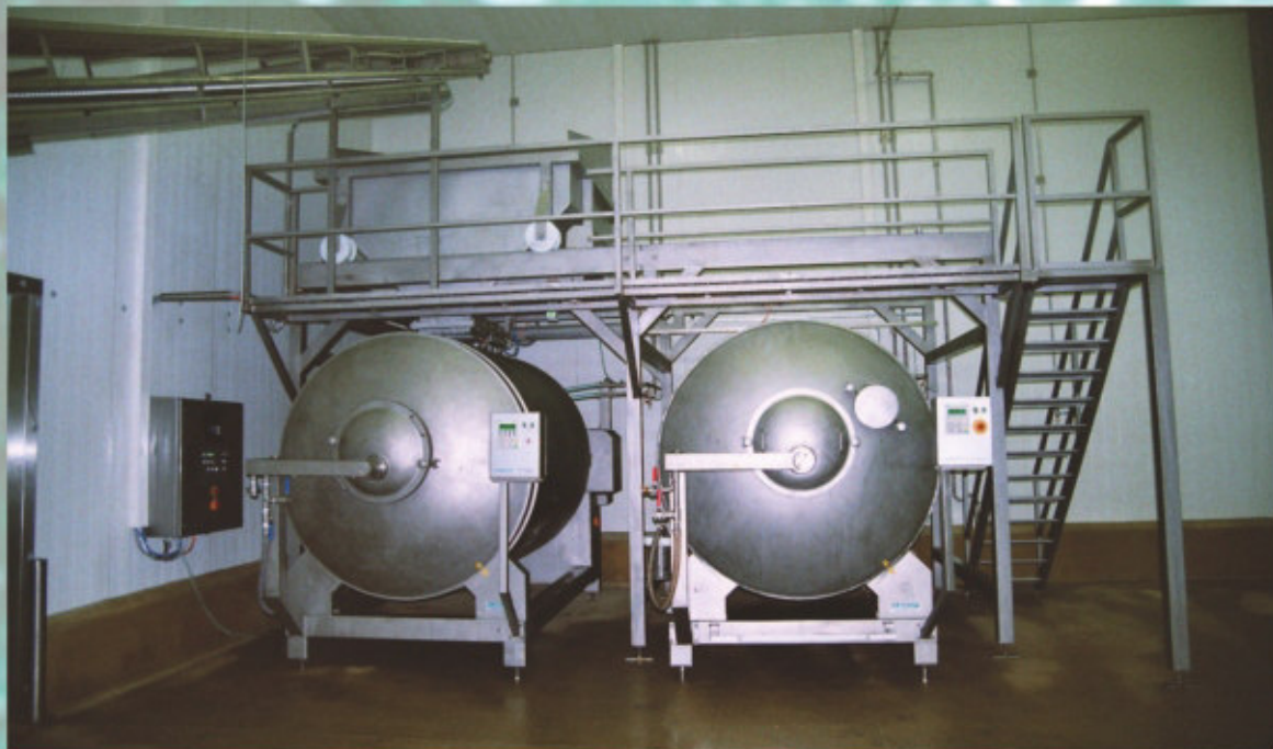
Vakuum-Kühl-Tumbler VKTH 2000 (2000kg) mit Förderband, Wiege-Vorrats-Trichter und Mantel-Beladung
